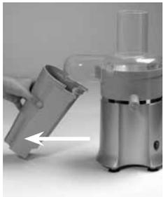
5. Drehen Sie die Saftschale im Uhrzeigersinn bis zum Anschlag und nehmen Sie die Saftschale zusammen mit dem darin liegenden Edelstahlsiebkorb ab. Der Siebkorb ist nur in der Saftschale eingelegt und fällt heraus, wenn Sie die Saftschale umkippen.
