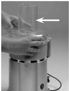
3. Drehen Sie den Entsafterdeckel im Uhrzeigersinn bis zum Anschlag, um den Entsafterdeckel zu entriegeln und nehmen Sie den Tresterbehälter heraus.
